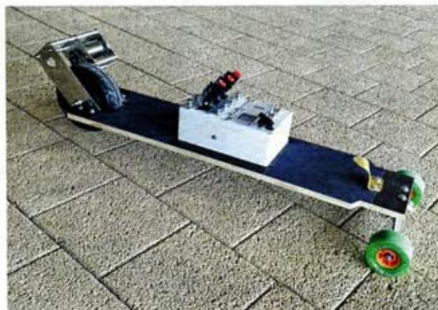
On avance plus ou moins vite grâce à des détecteurs de distance sur ce skate de Gennady Plyushchev.
